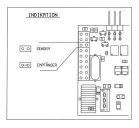
Diese Funktion betrifft den Pin 6 des Eingangssteckers. Mit der Schalttbrücke auf dem Programmiersstecker wählt man, ob das Synchronisationssignal gesendet oder empfangen wird.
