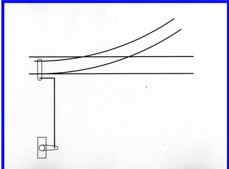
Diese Lösung eliminiert völlig die o.g. Fehler. Die Ursache liegt in der Biegung des Stellhebels um 90°und Ausnutzung der Flexibilität des Drahtes. Das Servo druckt (oder zieht) in die Endlage und das federn des Hebels druckt (oder zieht) die Zunge noch weiter.
