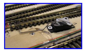
In manchen Fälle kann das Brummen des Servos stören – wenn die Grundplatte der Anlage als Resonanzkörper funktioniert. Das Phänomen kann durch Montage des Servos über Gummizwischenlage deutlich unterdrückt werden.
