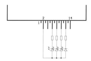
Für die externe Indikation ist es nicht notwendig, eine externe Versorgung einzurichten, jede Einheit hat auf dem Eingangsstecker auf dem Pin 2 die Spannung von +5 V zur Verfügung. Schaltbild der Indikation mit dieser Spannung ist in weiterem erklärt. Diese Spannung darf nur für die Indikation einer Einheit benutzt werden (nicht für andere Einheiten).
