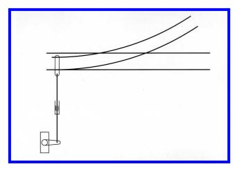
Diese Verbindung benutzt auch ein flexibles Element, hier das Spiralfeder (z. B. aus einem Kugelschreiber). Die Feder ist im Rohr gelagert, um die Parallelität des Hebels sichergestellt wird. Zum Schluß dieses Kapitels noch einige Bilder aus der Realität.
